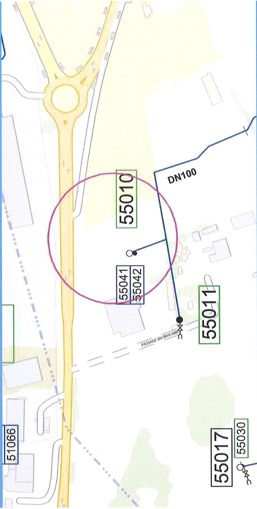
Le positionnement des réseaux SCP indiqué sur ce plan est indicatif, avec une précision de classe B. Lors d'une DT ou d'une DICT, il doit être précisé par un pré-repérage réalisé par la SCP, à la demande et à titre gracieux. Avant tous travaux à proximité, des sondages, à la charge du demandeur sont effectués en présence d'un agent SCP.
